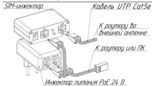
Схема 2 – PoE подключение SIM-инжектора
