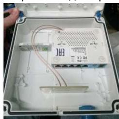
ТЗ: Максимально бюджетное устройство с промышленным производительным роутером mikrotik. Надежный LTE модем. Легкая интеграция с системой мониторинга/управления. Питание 12/24В. Влагозащищенный корпус. Доработать WiFi антенну роутера.
