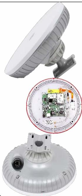
Устройство предназначено для усиления и приема сигнала 3G/LTE. Обладает герметичным корпусом IP68, промышленный модем, производительный роутер mikrotik, фазированная антенная решетка с коэффициентом усиления 14дБи (MIMO). Опционально комплектуется устройством удаленная сим-карта (вне корпуса антенны). Питание, управление и передача данных по одному кабелю снижения типа витая пара.
